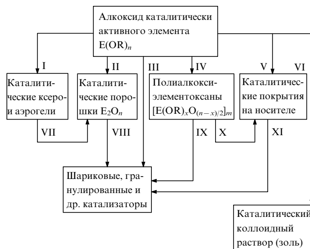
Рис. 1. Основные направления получения полупродуктов и каталитических материалов из алкоксидов каталитически активных элементов.
